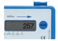
Wenn ein Gerät über Bluetooth mit dem UltraLink verbunden ist, blinkt die Diode alle zwei Sekunden blau. Durch kurzes Drücken der Modus-Taste können Sie den angezeigten Parameter ändern. Wenn die Taste länger als 5 Sekunden gedrückt wird (langes Drücken), wird das Konfigurationsmenü sichtbar. Der Pfeil am unteren Rand des Displays zeigt den aktuellen Parametertyp und die Einheit an.
