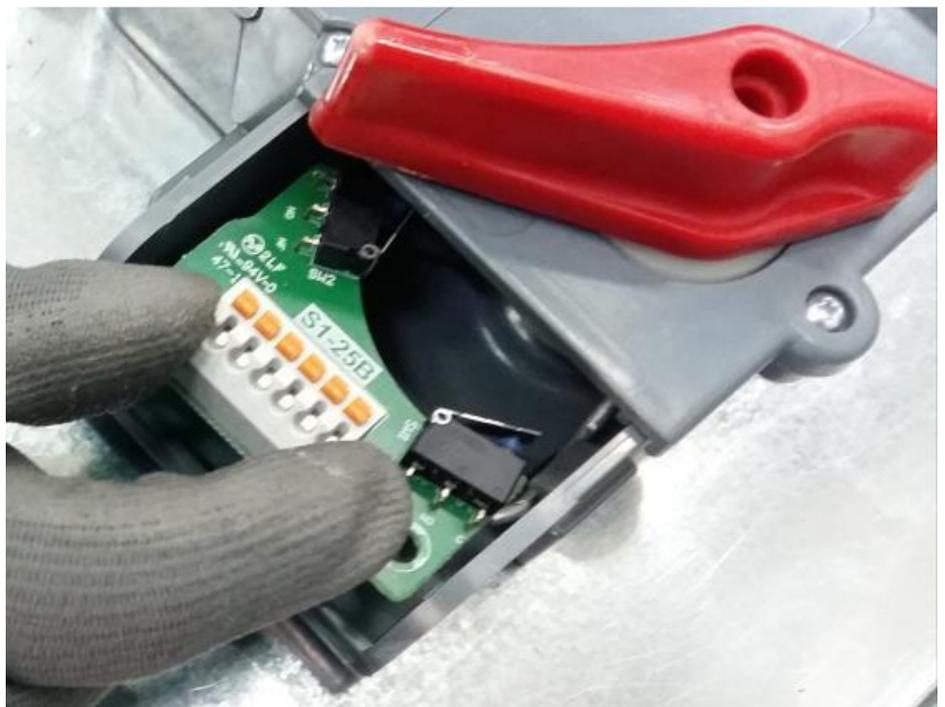
Setzen Sie eine neue Steuerkarte ein.
