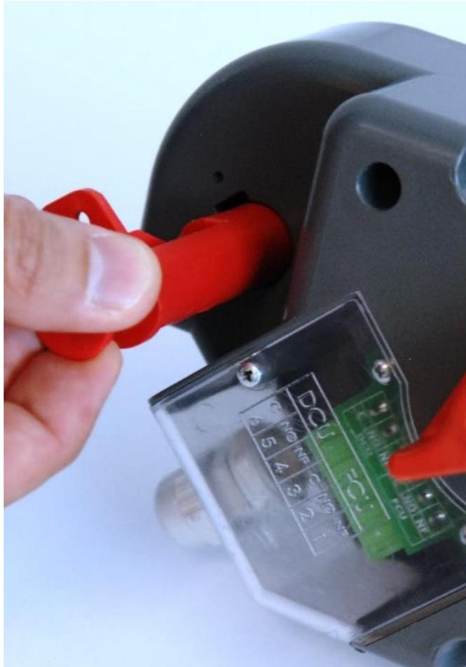
**1.3.** Entfernen Sie die defekte Sicherung. Haken Sie die neue Sicherung ein.
