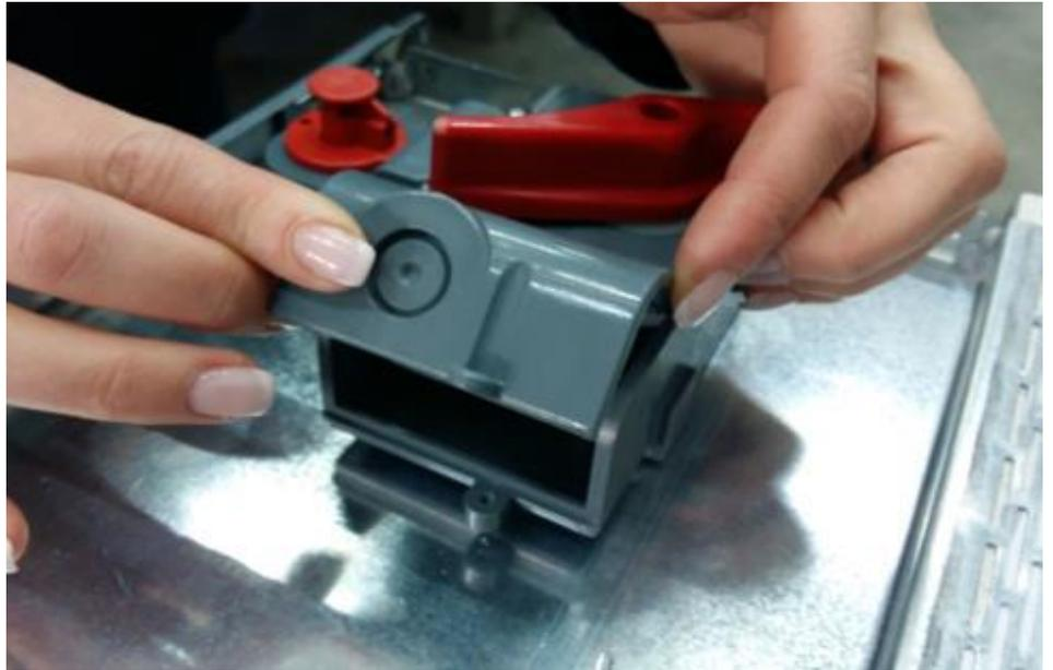
Befestigen Sie die Abdeckung auf dem Gehäuse mit der Schraube.
