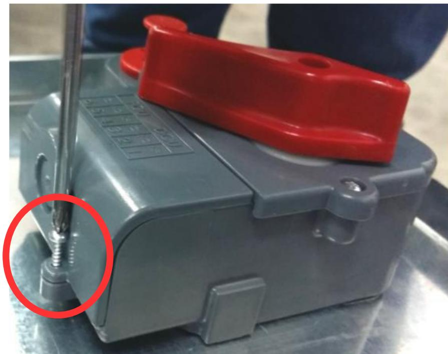
Entfernen Sie die Abdeckung der Steuerkarte
