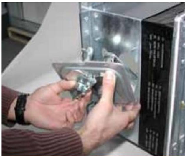
6.1.3. Montieren Sie nun die neue Montageplatte WK45MTB und befestigen Sie diese mit den 4 Schrauben. Überprüfen Sie, dass der Bolzen „B“ des Steuerhebels korrekt in der Seitenblattstütze „A“ eingesetzt ist.
