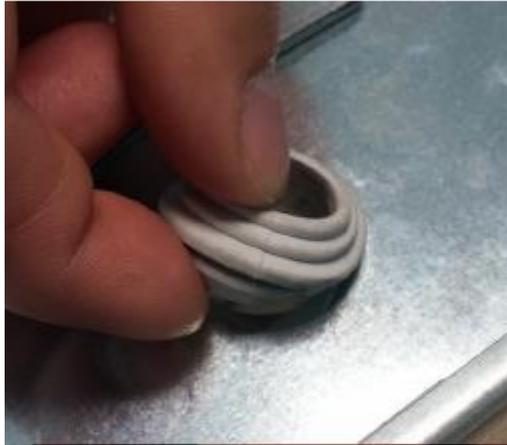
5.2.2. Schneiden Sie den oberen Teil der Gummiabdeckung mit einem Cutter ab.
