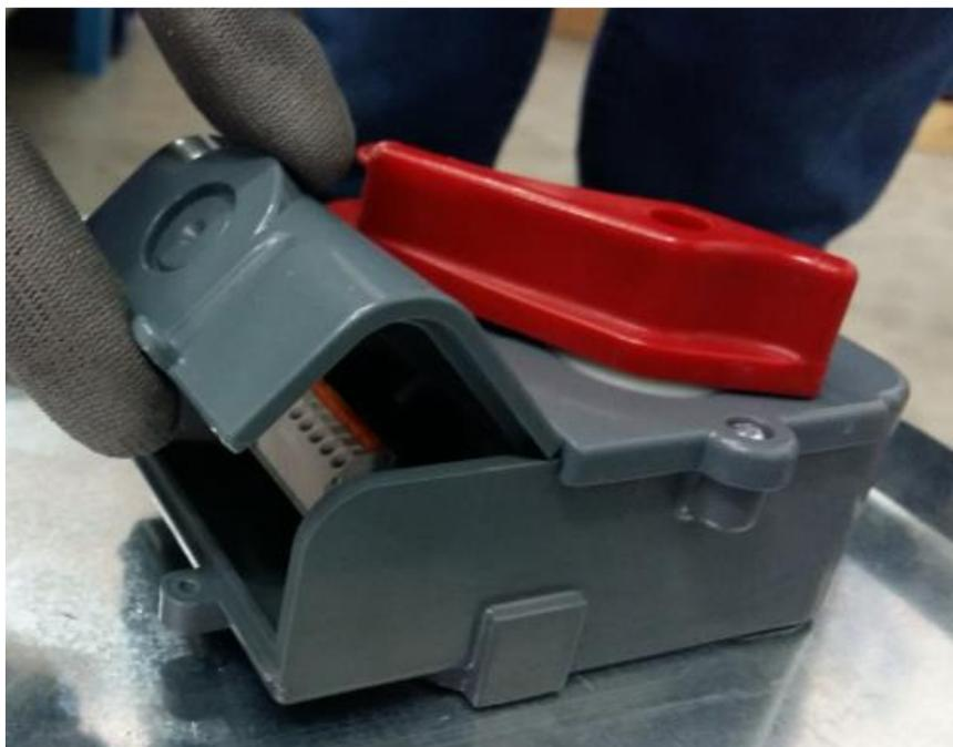
Lösen Sie die Schrauben von der Steuerkarte
