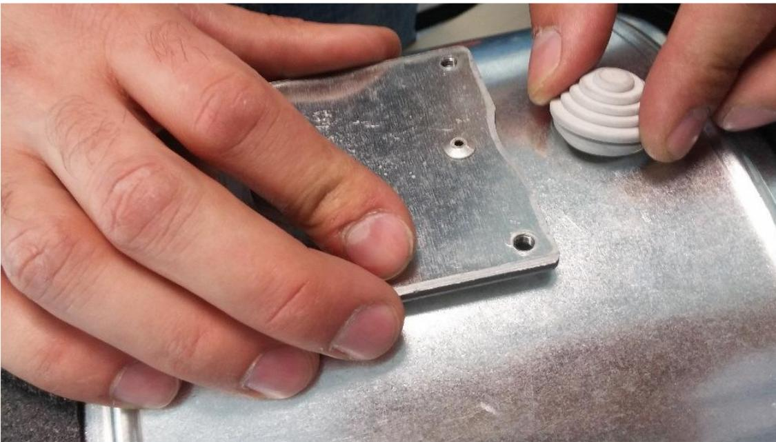
4.2.1. Platzieren Sie die Motorstützplatte wie gezeigt unten. Stellen Sie sicher, dass Sie die Konsole genauso platzieren, wie auf der Abbildung angegeben.
