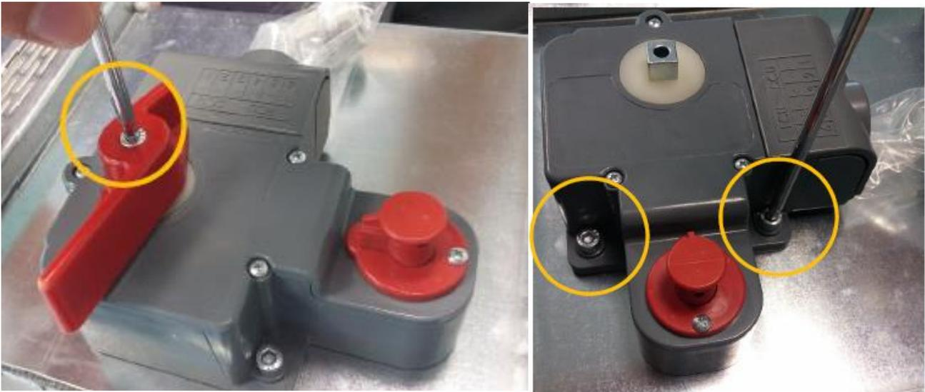
5.1.2. Entfernen Sie den manuellen Kompaktmechanismus, indem Sie die Einheit vorsichtig nach oben ziehen.
